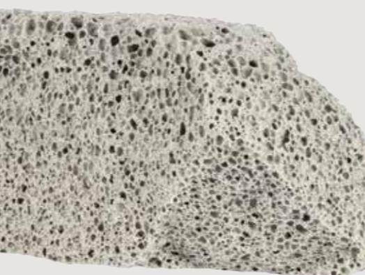
Für Perimeterdämmungen bis zur Passivhaus-Bauweise, aber auch als Leichtschüttung für befahrene Flächen mit normalen Lastanforderungen. Hervorragender Dämmwert im Neubau und für Sanierungen. Hohe Standfestigkeit, bis Nutzungsklasse N2.
